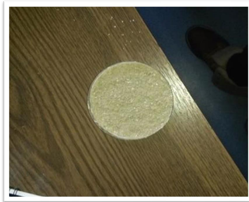
Şekil-2: Mandalina kabuklarından elde edilen uçucu yağın zeolite absorbe edilmiş hali
