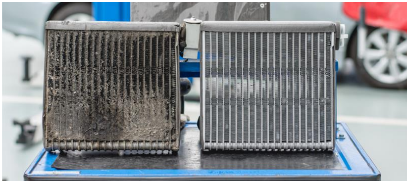
Şekil 1. Kirliliği (Sol) ve Temizliği (Sağ) Klima Evaporatörleri. (4)
